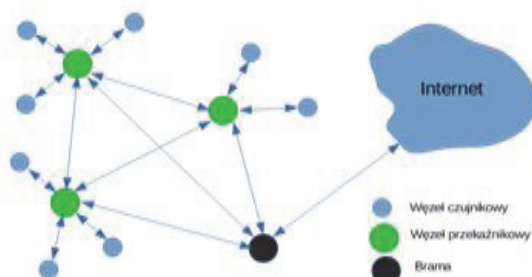
Rys.1. Uproszczona architektura systemu IIBSC
